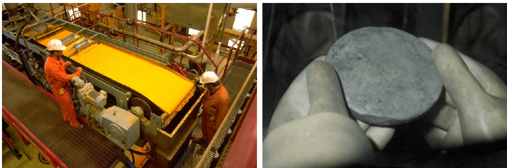
FIGURE 7 : A gauche : concentrés d'uranium ou « Yellow cake », société des mines de Jouac (Haute-Vienne, Limousin). La répartition isotopique en masse de l'uranium naturel est de 99.3% d {}_{92}^{238}\text{U} et 0.7% d {}_{92}^{235}\text{U} . L'activité de l'uranium est faible et ne demande pas des mesures de radioprotection importantes pour le personnel. A droite : plutonium à l'état métallique. Les isotopes du plutonium sont des émetteurs de rayons \alpha . Les émetteurs \alpha ne posent pas de risques tant qu'ils ne sont pas inhalés ou ingérés. La couche morte de l'épiderme suffit à les arrêter : on peut le tenir avec de simples gants (images issues de : http://www.laradioactivite.com )
