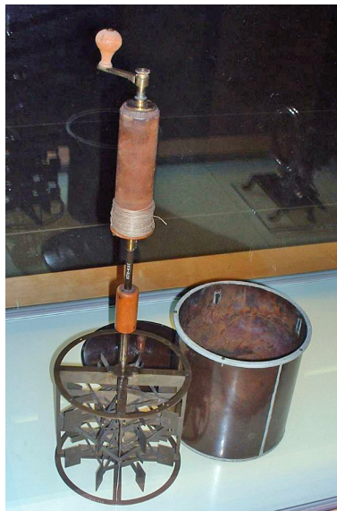
FIGURE 6 – Expérience de Joule : dans un système adiabatique, n'échangeant que du travail avec l'extérieur, Joule mesure l'élévation de température due au travail des pales d'un agitateur, et montre que W = Q . (image issue de : http://www.wikipedia.org )
