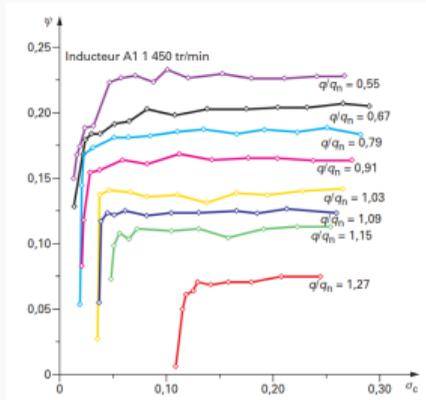
A débit constant et  $\omega$  constant, la HMT chute à basse pression d'entrée (petit  $\sigma$ ).
