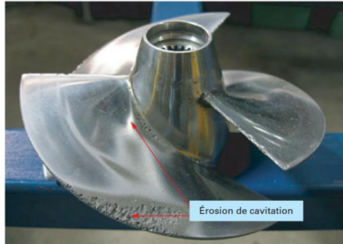
Les implosions répétées des poches de cavitation altèrent progressivement la structure cristalline du matériau et peuvent détruire très rapidement les aubes de la roue : c'est le phénomène d'érosion par cavitation.
