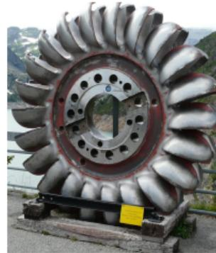
Roue de turbine hydraulique Pelton **Incompressible**
