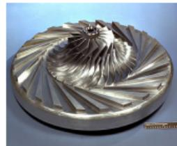
Turbine centripète sur gaz d'échappement
