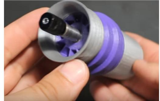
L'objectif du cas d'étude est de concevoir et réaliser une petite turbine permettant d'entraîner à haute vitesse un outil en utilisant comme source d'énergie l'écoulement produit par un aspirateur ménager. Un exemple est présenté sur la figure avec un outil à tronçonner.
