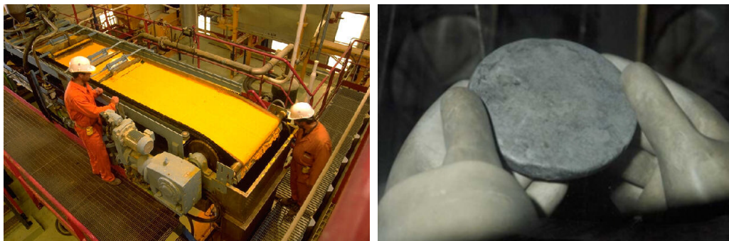
FIGURE 7 – A gauche : concentrés d'uranium ou « Yellow cake », société des mines de Jouac (Haute-Vienne, Limousin). La répartition isotopique en masse de l'uranium naturel est de 99.3% d {}^{238}_{92}\text{U} et 0.7% d {}^{235}_{92}\text{U} . L'activité de l'uranium est faible et ne demande pas des mesures de radioprotection importantes pour le personnel. A droite : plutonium à l'état métallique. Les isotopes du plutonium sont des émetteurs de rayons \alpha . Les émetteurs \alpha ne posent pas de risques tant qu'ils ne sont pas inhalés ou ingérés. La couche morte de l'épiderme suffit à les arrêter : on peut le tenir avec de simples gants (images issues de : http://www.laradioactivite.com )
